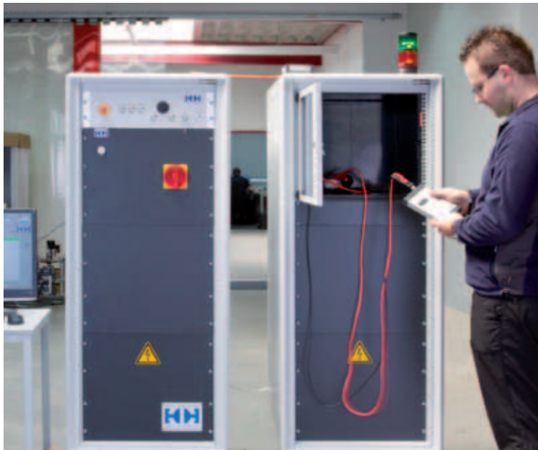
Grundaufbau eines Teilentladungsprüfplatzes Basic layout of a partial discharge testing station
